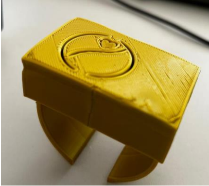
Figura 2: Protótipo físico final do SafeCare, com o circuito embarcado no case e acoplado ao bracelete impresso em 3D.
