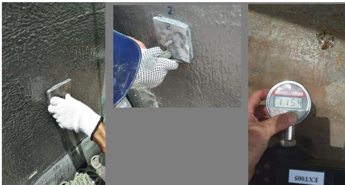
Teste de arrancamento
