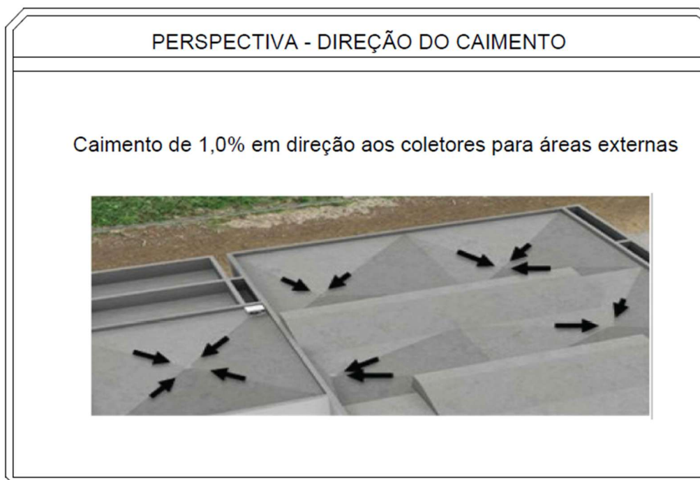
Caimento da regularização para áreas externas
